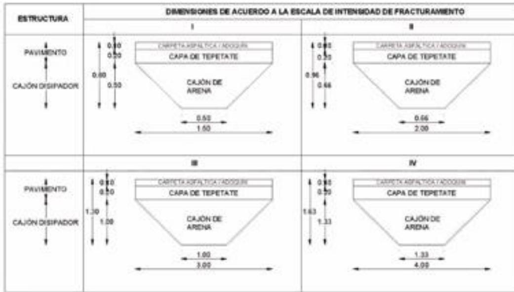
Fig. 3.12.1 Especificaciones complementarias para la implementación de cajas disipadoras en vialidades
