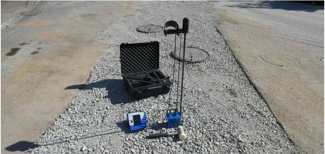
Figura E.5 Equipo utilizado en los ensayos de penetración PANDA.
